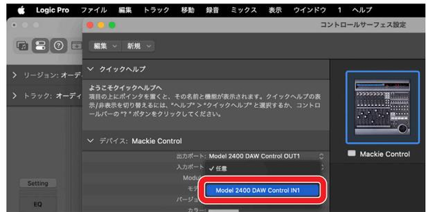
7. 再び手順4から同様に行い、出力ポートに「Model 2400 DAW Control OUT2」、入力ポートに「Model 2400 DAW Control IN2」を設定する。
