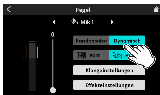
Pegel- und weitere Einstellungen für den Mikrofoneingang
