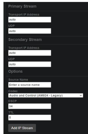
5. Ajuste el códec de audio de stream con el elemento Codec de la zona de ajustes de stream ( ④).
