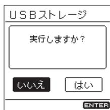
4. 「はい」を選択し、ENTER/MARKボタンを押します。USBストレージモードになり、パソコンと接続されます。
