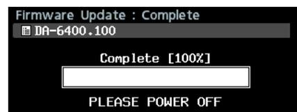
10. 本体のSTANDBY/ONスイッチを押して、電源を切ります。
