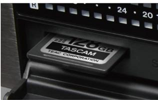
PCM 192kHz に加え DSD 2.8/5.6MHz フォーマットで最大 512GB の SD カードに録音可能。複数台のカスケード接続を行えば録音・再生ともにサンプル精度での同期走行を実現。DSD マルチトラック録音環境も構築することができます。
