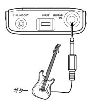
本機はギター専用入力端子、ギター用エフェクターを装備していますので、エレキギターを本機に直接接続するだけでさまざまな音色で演奏することができます。また再生音に合わせてギターを演奏することもできます。(→16ページ「内蔵エフェクタを使う」)
