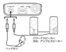
本機の  $\Omega$  / LINE OUT 端子にヘッドフォンまたはモニターシステム (アンプ内蔵スピーカー、アンプ/スピーカーシステムなど) を接続します。
