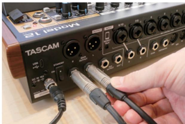
Model 12 の音をモニター・スピーカーで聴くには、スピーカーを「**MAIN OUT**」または「**SUB OUT**」端子に接続してください。スピーカーの音量は MAIN、または SUB フェーダーで調整することができます。
