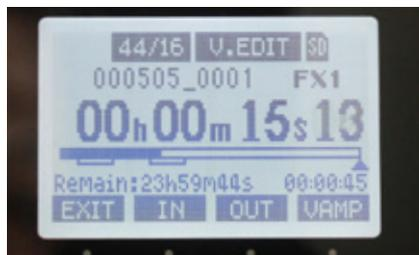
**5** VAMP ポイントはイン / アウトポイントで再度「F-2 / F-3」ボタンを押して個別に削除するか、VAMP 画面内の「I/O ALL CLEAR」機能で一括削除が行えます。
