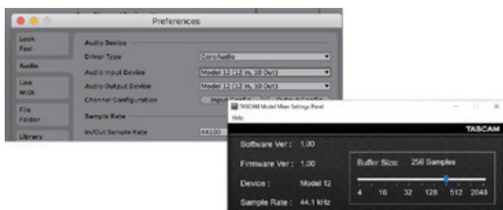
背面の USB Type-C コネクタでパソコンと接続することで、12 入力 / 10 出力の USB オーディオインターフェースとして使用することができます。
