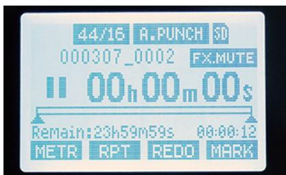
**4** ホーム画面に「A.PUNCH」アイコンが表示されていることを確認し、パンチインしたいトラックの「REC」ボタンを押してから「●」ボタンで録音を開始します。
