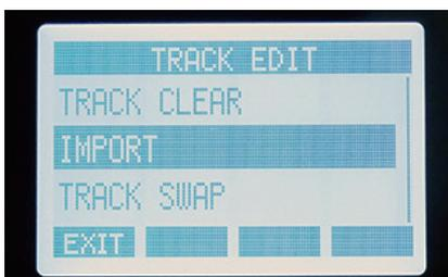
**6** インポートするトラックを選択し「F4 (OK)」ボタンを押してインポートを実行します。インポートできるのは空のトラックのみです。空のトラックがない場合はエラーメッセージが表示されます。
