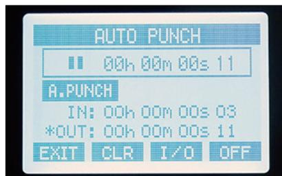
**3** ポイントが設定できたら再生を停止させ「F4 (ON)」ボタンを押してオートパンチイン／アウト機能を有効にします。設定が完了したらホーム画面に戻ります。
