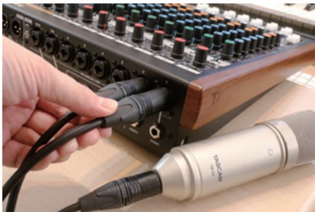
マイクは「**マイクケーブル (XLR)**」を使って、「**XLR/TRS コンボジャック (チャンネル 1 ~ 9/10)**」に接続してください。Model 12では最大8本のマイクを同時に接続して使用することができます。
