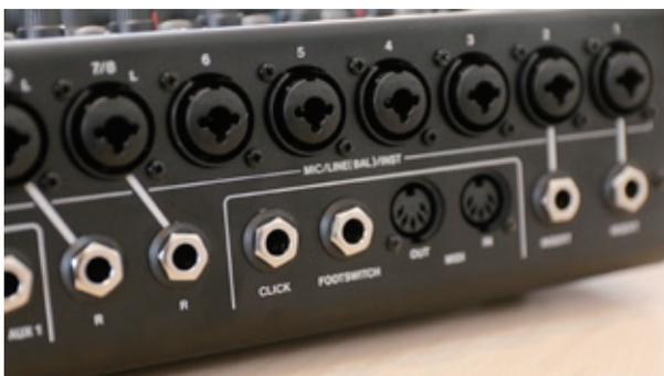
Model 12 は、メイン出力とは別系統の完全に独立したクリック専用出力端子を搭載しています。個別にクリックを聴くことができ、ライブのオケ出しにも活用できます。
