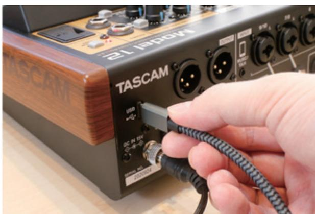
パソコンと接続する場合は、「USB ケーブル (Type-A - Type-C や Type-C - Type-C)」を使って、パソコンの USB2.0 ポートに接続してください。
