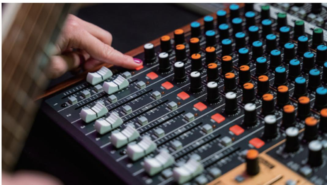
Model 12 には、12トラックを最大 48kHz/24bit の WAV ファイルで直接 SD カードへ録音できるマルチトラックレコーダー (MTR) 機能が搭載されています。MTR の世界で長年に渡り培ってきた TASCAM ならではの使いやすさを実現。こだわりの作品作りに必須の、パンチイン・パンチアウトやオーバーダブ録音も可能です。
