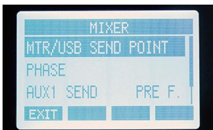
**2** 取り出し位置を変更したいチャンネルを選択して、ダイヤルを押します。「F4 (ALL)」ボタンを押すと、すべてのチャンネル設定を一括して変更することができます。
