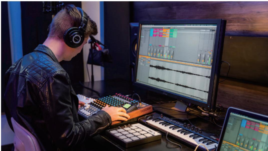
Model 12 は、DAW のフィジカル・コントローラーとしても使用することができます。HUI/MCU プロトコルを採用し、主要な DAW ソフト（※）に対応。フェーダーやミュート、パン、ソロなどのミキシング操作および再生、録音、早送り、早戻し、JOG などのトランスポート操作がマウスに触れることなく、アナログライクに行えます。
