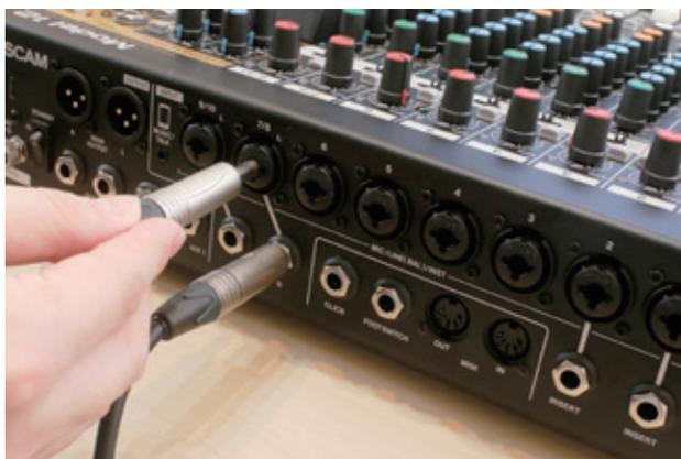
キーボード/シンセサイザーやリズムマシンは「標準フォンケーブル」を使って、「XLR/TRS コンボジャック (チャンネル 7/8、9/10)」端子に接続してください。7/8、9/10 はステレオチャンネルのため、ステレオ楽器を扱うのに適しています。
