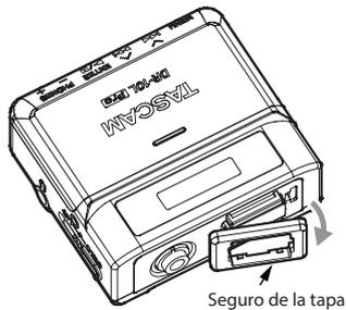
2. Después de retirar la tapa del conector, introduzca el AK-BT1 en la unidad.
