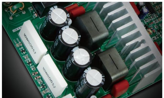
アンプは高効率の Class-D 方式を採用。コンパクトな本体サイズながら、ローインピーダンス接続時 120W × 2ch @4Ω / 8Ω、ハイインピーダンス接続時 240W × 1ch、100V / 70V の高出力を実現します。
